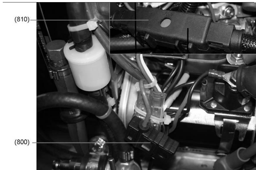
III. 9-5: Reservedele til sikringerne
