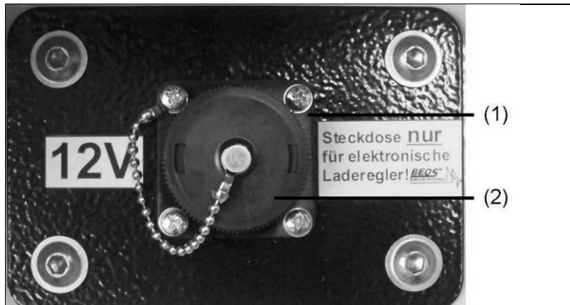
III. 5-8: Tilslutning af anordning til opretholdelse af batteriets ladeniveau
