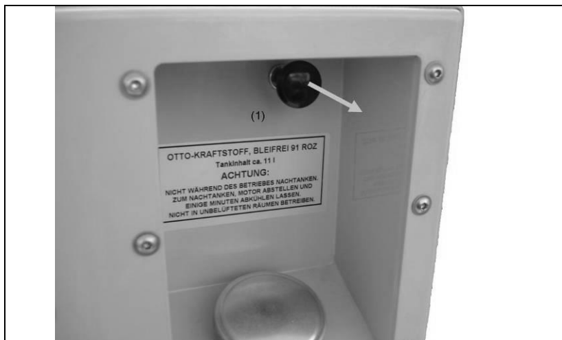
Illustration 4-1 : Tirez sur le starter
