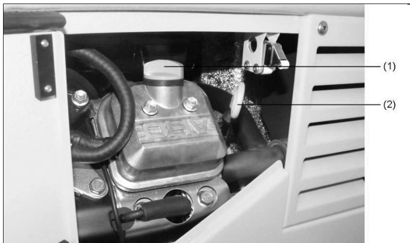
Ilustracja 6-1: Miarka kontroli poziomu oleju
