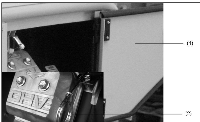
Ilustracja 4-1: Uruchamianie ssania ręcznego
