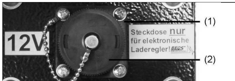
Ilustracja 5-8: Podłączenie przyrządu do podtrzymywania ładowania akumulatora
