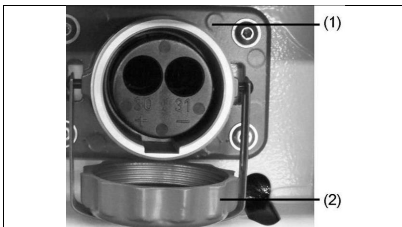
Ilustracja 5-6: Podłączanie zewnętrznego przyrządu rozruchowego
