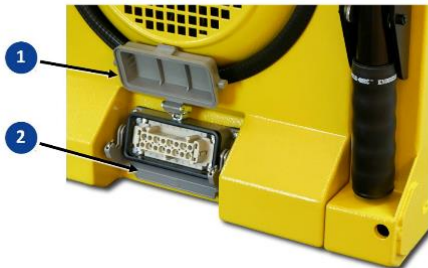
Sl. 9-5 Uređaj za daljinsko startovanje sa HARTING® utičnicom
