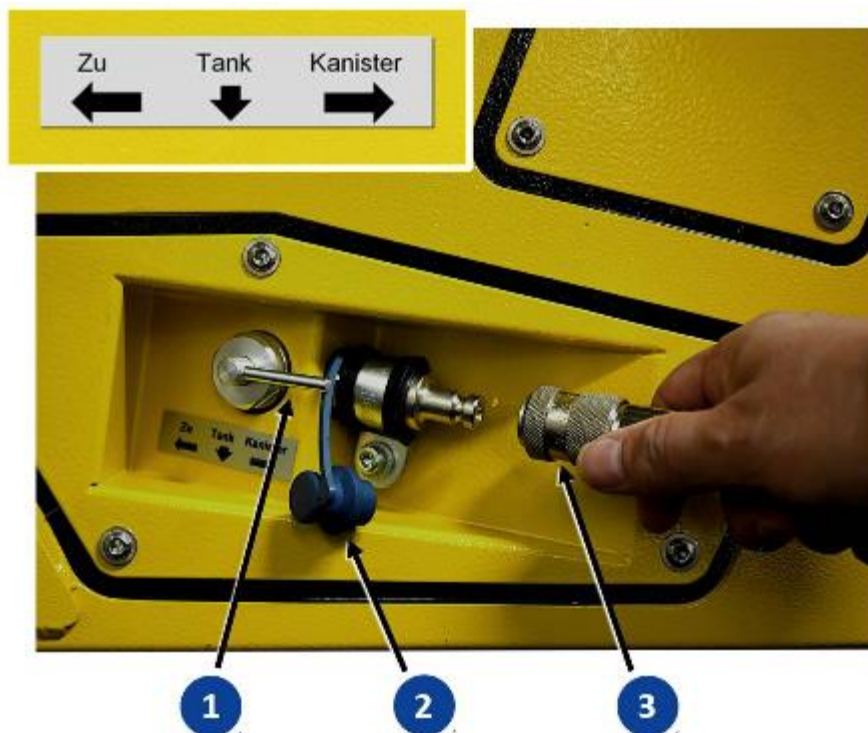
Sl. 8-6 Priključak za uređaj za dolivanje rezervoara
