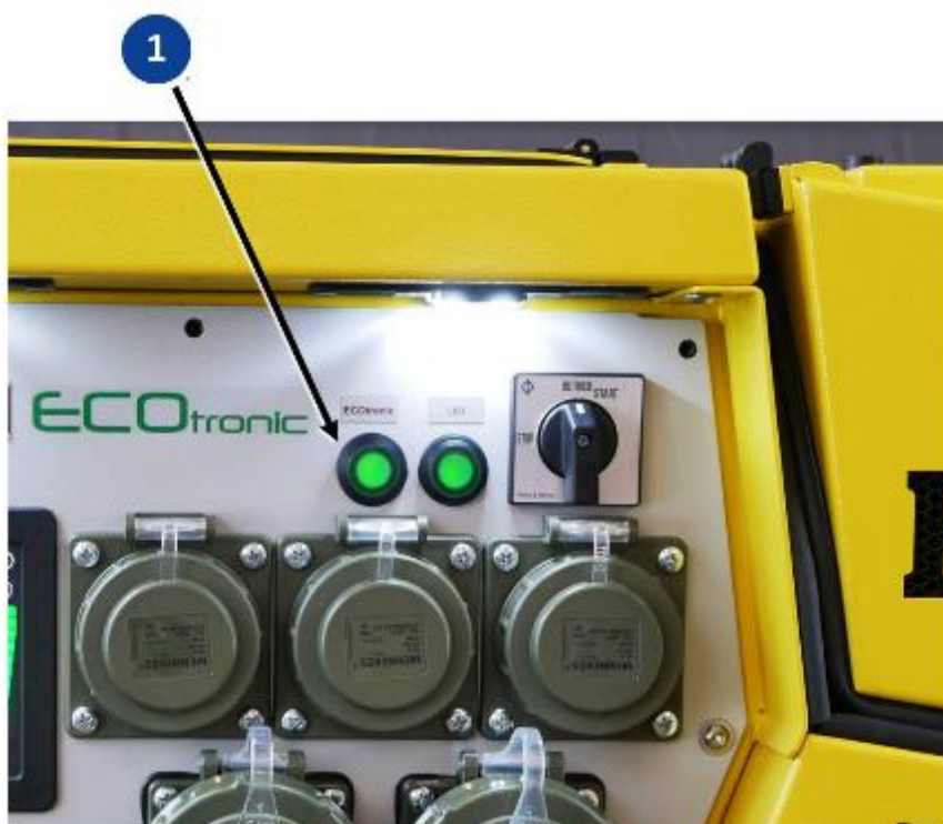
Sl. 8-2 ECOtronic spuštanje broja obrtaja za prazan hod
