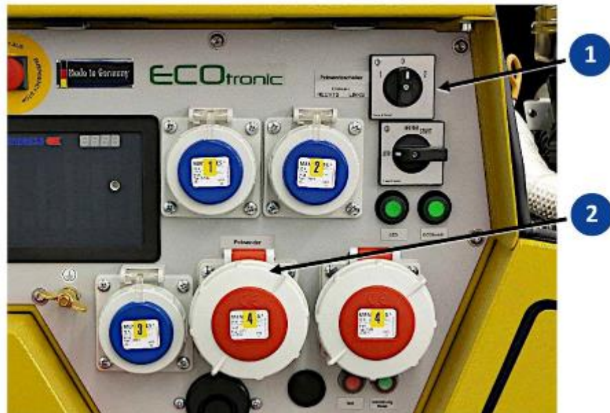
Sl. 9-9 Primer prekidača za promenu polariteta
