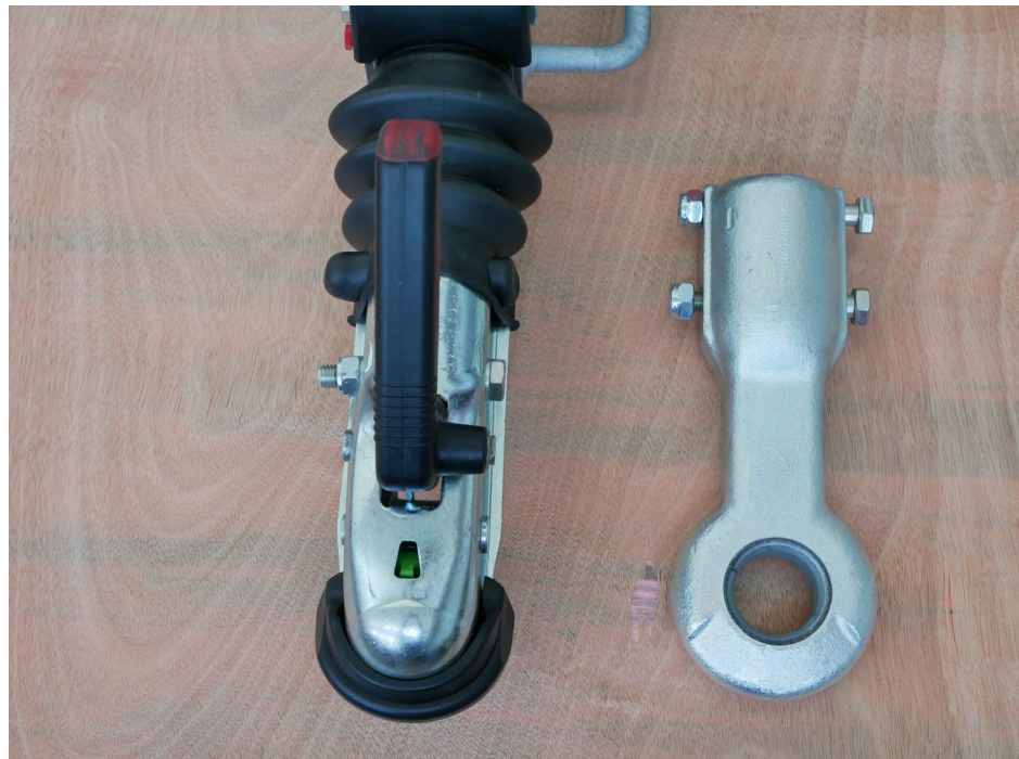
Abb. 9-7 Zugkugelpkupplung und DIN-Zugöse
