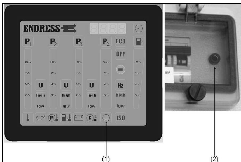
Obr. 4-4: Kontrola ochranného (zemníčho) vodiče
