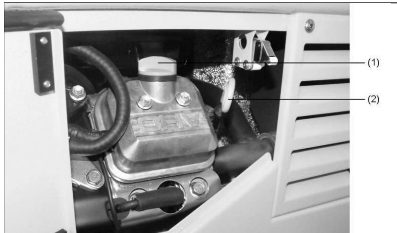
Fig. 6-1: Varilla de medición de aceite
