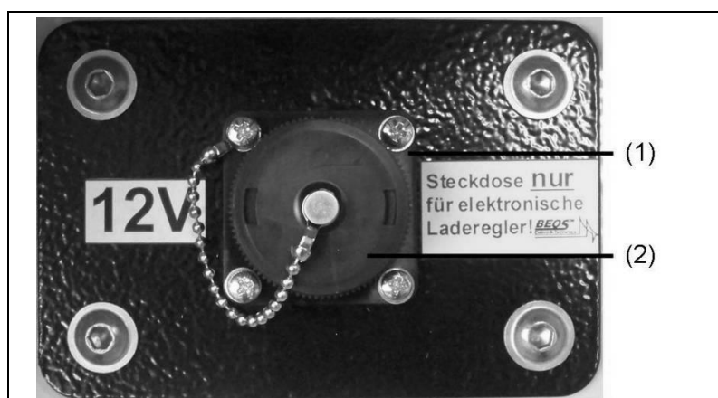
Fig. 5-9: Presa della corrente di carica BEOS
