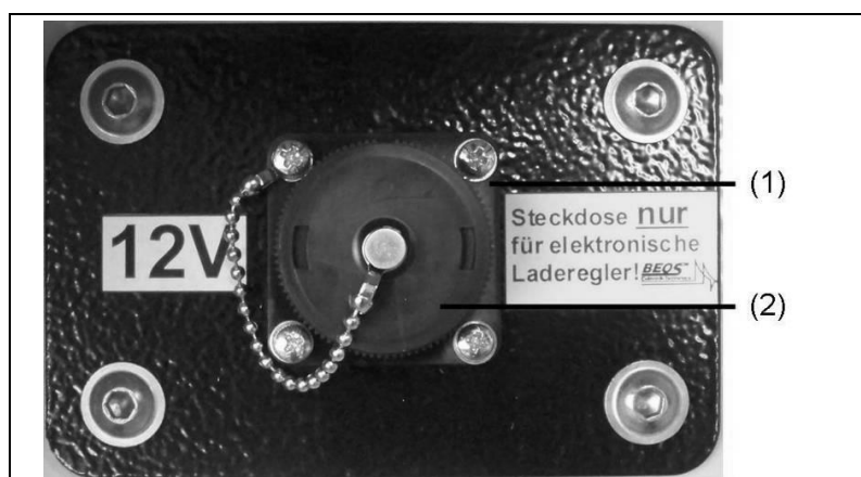
Sl. 5-8: Vtičnica BEOS za polnilnik tok
