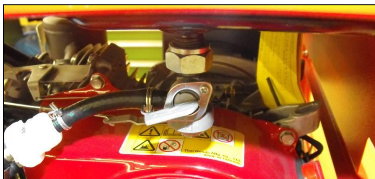
Obr. 4.5: Uzavření uzavíracího kohoutu palivového potrubí
