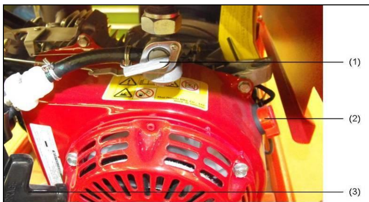
Obr. 4.1: Otevření / uzavření uzavíracího kohoutu palivového potrubí
