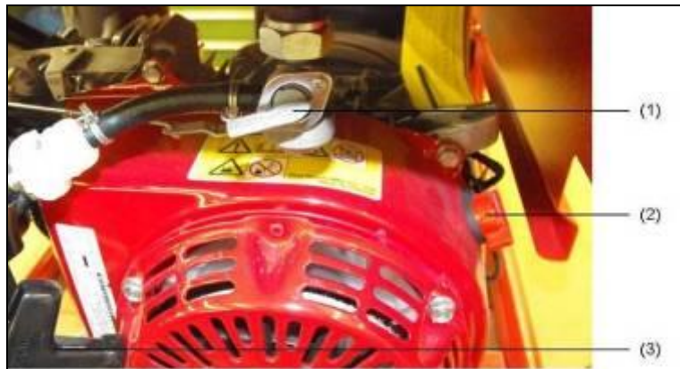
Abb. 4.1: Kraftstoffhahn öffnen / schließen
