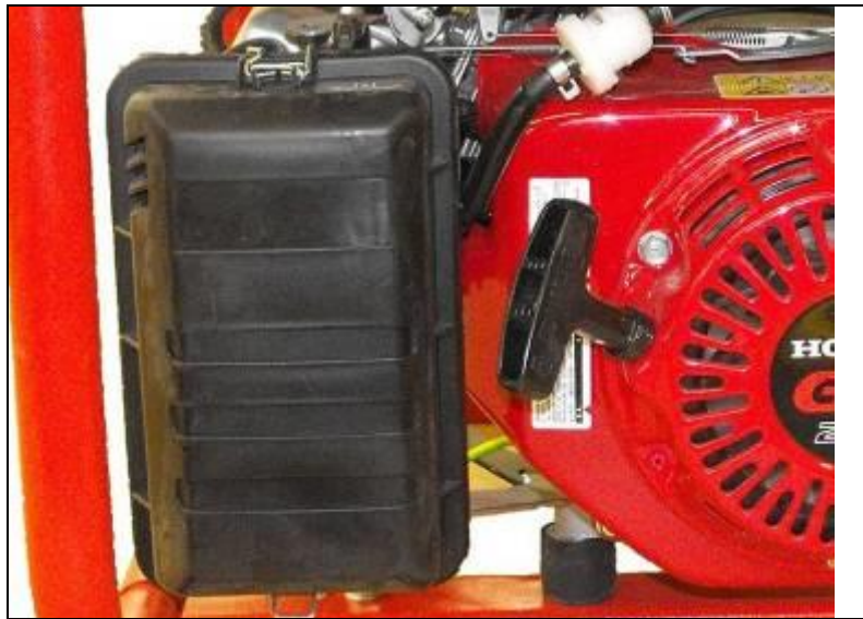
Sl. 4.7: Odstranitev zračnega filtra
