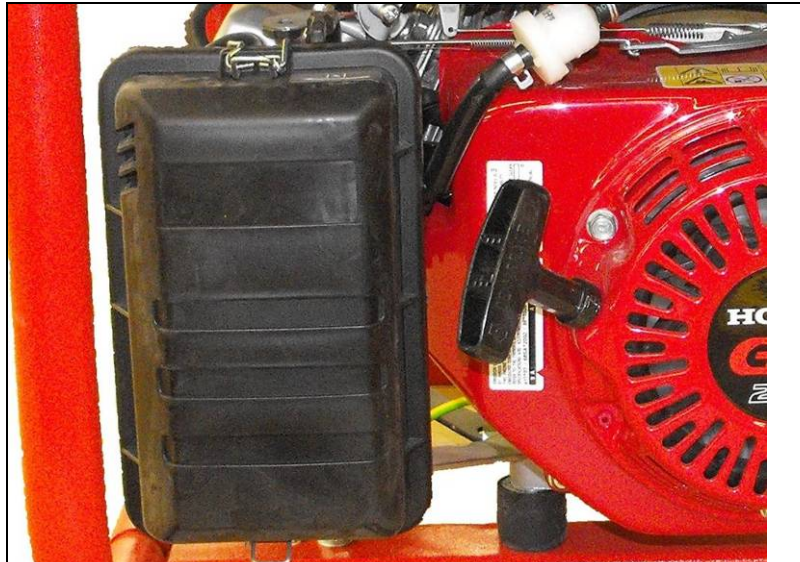
Afb. 4.7: Verwijder het luchtfilter
