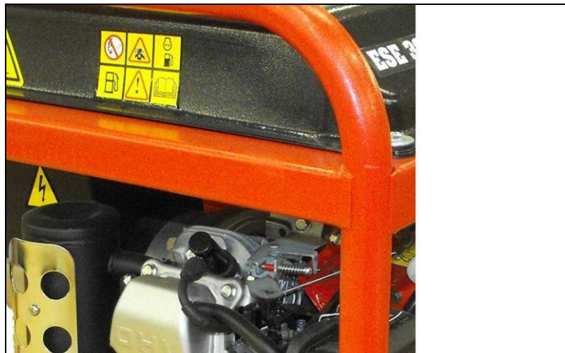
Fig. 4.6: Lossa tändstiftets kontakt
