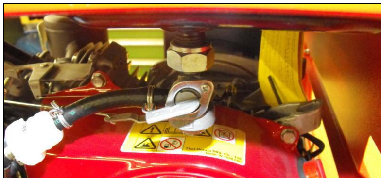
Rys. 4.5: Zamknięty zawór paliwa
