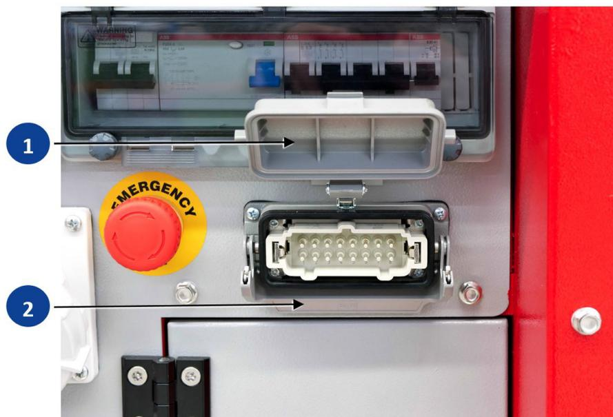
Abb. 8-6 Fernstarteinrichtung mit HARTING®-Steckdose
