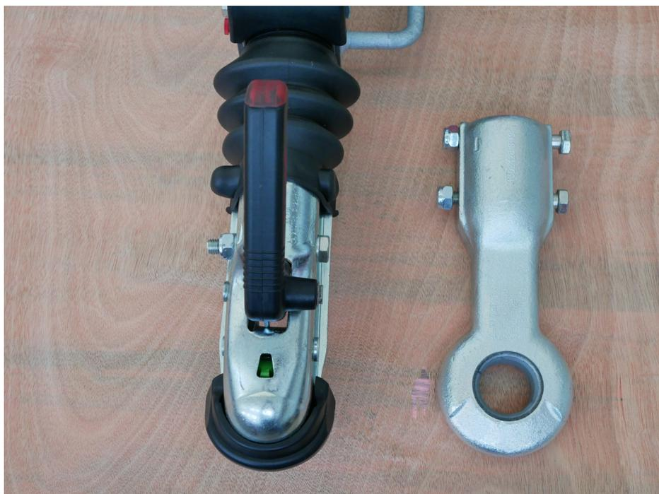
*Abb. 9-5 Zugkugelkupplung und DIN-Zugöse*
