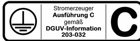
Kennzeichnung der Ausführungsklasse C auf dem Gerät
