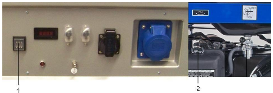
Εικ. 4.4: Απενεργοποίηση του κινητήρα
