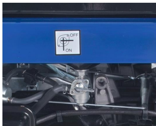
Εικ. 4.1: Ανοίξτε / κλείστε τον κρουνο καυσίμων
