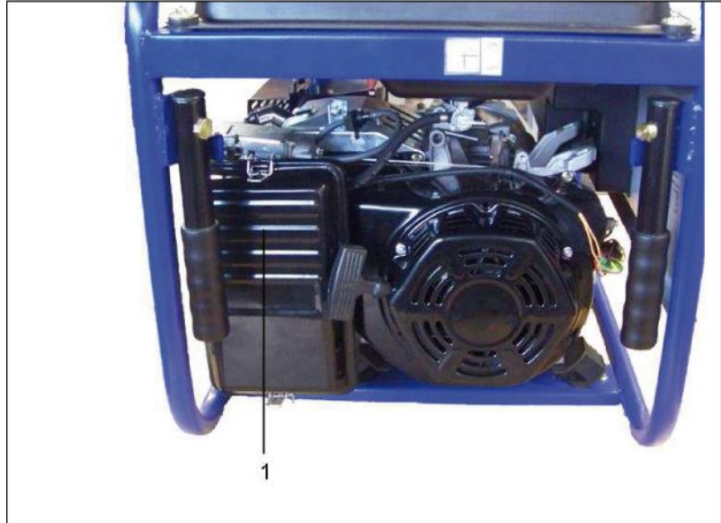
Fig. 4.8: Ta av luftfilteret
