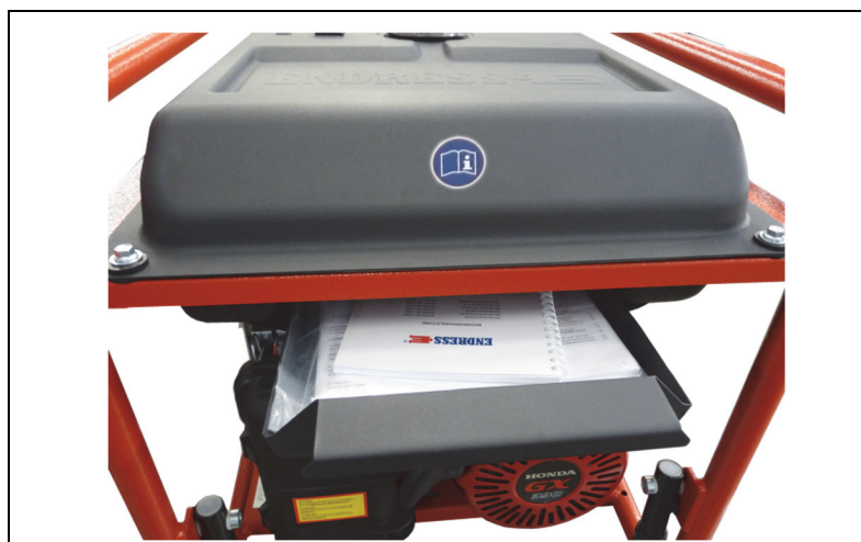
Obr. 1-1: Přihrádka na dokumenty pod palivovou nádrží
