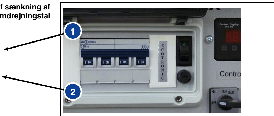
Ill. 4-8: Vippekontakt på sænkning af tomgangs-omdreningstal
