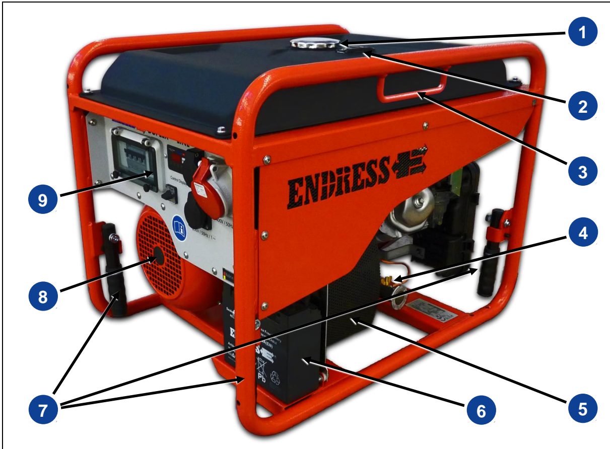
Fig. 3-2: Componentes del lado del generador eléctrico y del lado de los gases de escape
