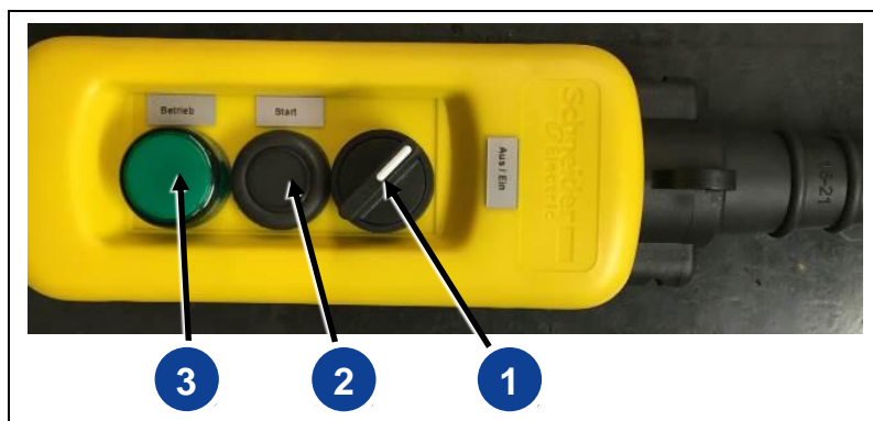
Sl. 5-4: Kabelsko daljinsko upravljanje
