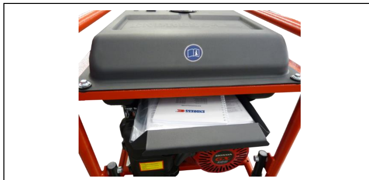
Rys. 1-1: Półka na dokumenty poniżej zbiornika na paliwo
