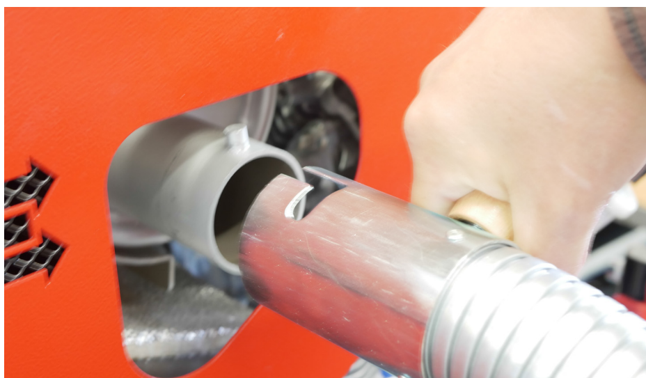
Rys. 8-5 Podłączenie węża spalinowego
