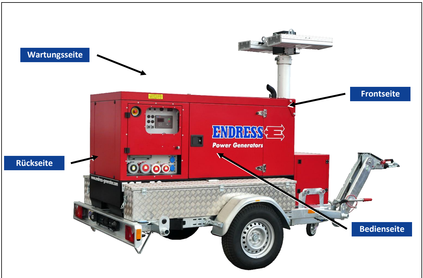
Abb. 5-1 Ansichten der Mobilgenflutlichtanlage
